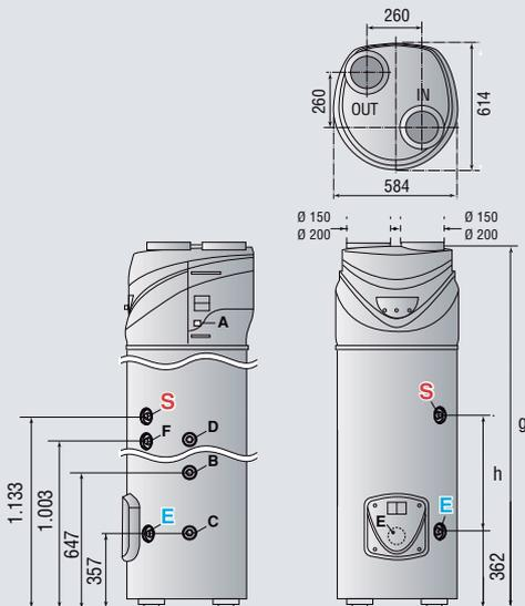
Diámetros conexión conducción aire disponibles de serie (in y out): Ø150 mm, Ø200 mm.
